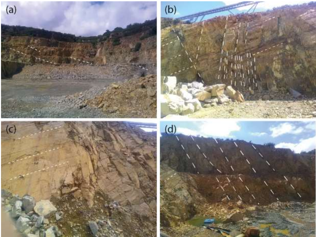
Illustration 118 : (a et c)) photographie montrant la foliation discrète, mais néanmoins ubiquiste, caractéristique des orthogneiss de la carrière de Lannurien. (b et d) photographie montrant le réseau de fractures conjuguées parfois très rapprochées (i.e., schistosité de fracture) omniprésent dans la carrière de Lannurien (BRGM)
