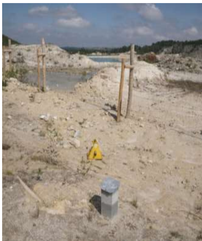
Illustration 39 : Piézomètre de 17 m de profondeur situé au sud de la carrière de Berrien (BRGM, 2022)
