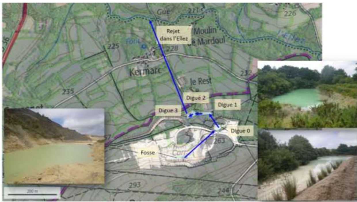
Illustration 67 : Circuit de l'eau d'exhaure actuel dans la carrière Le Rest à Loqueffret (fond BD ORTHO IGN et carte IGN 1/25 000 - photographies BRGM)
